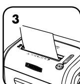
Если функция отключена, работа устройства будет продолжаться, но при загрузке слишком большого количества бумаги может произойти застревание и загорится значок «Удалить бумагу» (↑↓).
