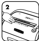
Berør testfeltet og sjekk om SafeSense®-indikatoren lyser
