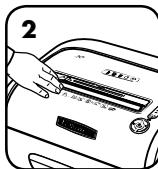
Dotknite sa testovacej oblasti a skontrolujte, či sa rozsvietil indikátor funkcie SafeSense®
