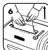
Se os passos 4 e 5 não forem úteis para desencravar a máquina, inverta por completo o papel, retire várias folhas e coloque-as novamente
