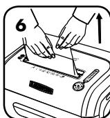
Εάν με τα βήματα 4 και 5 δεν αποκατασταθεί η εμπλοκή, αναστρέψτε μέχρι τέρμα το χαρτί, αφαιρέστε αρκετά φύλλα και επαναλάβετε την τροφοδότηση
